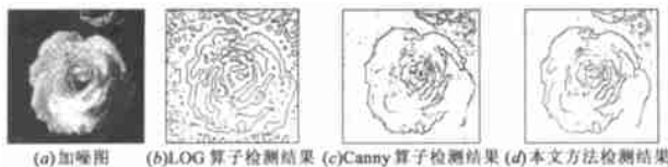
图 6 对迭加分布为 N(0, 20) 的高斯噪声的 rose 图, 用 LOG 算子, Canny 算子的检测结果和本文方法检测结果的比较
